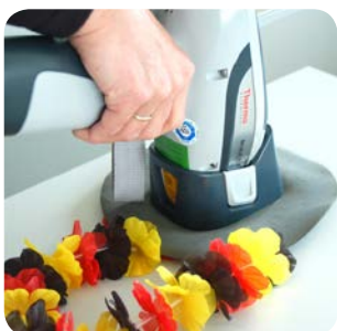
Röntgenfluoreszenzanalysator Ermittlung von 30 Schwermetallen
